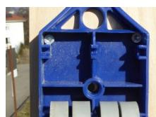
Zum verschließen der Tür wurden Scharniere befestigt, deren Achse entfernt und durch einen herausziehbaren Stab ersetzt. Entsprechend der früheren Modifikationen wurde auch hier ein U-Profil als Stabilisierung am Ende des Presskastens eingebaut.
